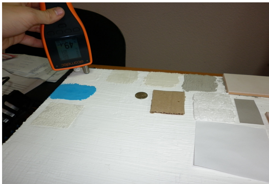
Рис. 1.2 — Измерение температуры на поверхности теплоизоляционного слоя Корунд®
